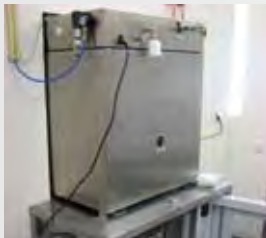
Stufa di essiccazione a vuoto di sicurezza per accesso dell'utilizzatore solo dal lato camera pulita
